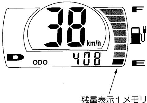
残量表示が4メモリから3メモリ、3メモリから2メモリ、2メモリから1メモリになった時に、断続ブザー（ピッピッピッ）で知らせます。ブザーは15秒間で鳴り止みます。
